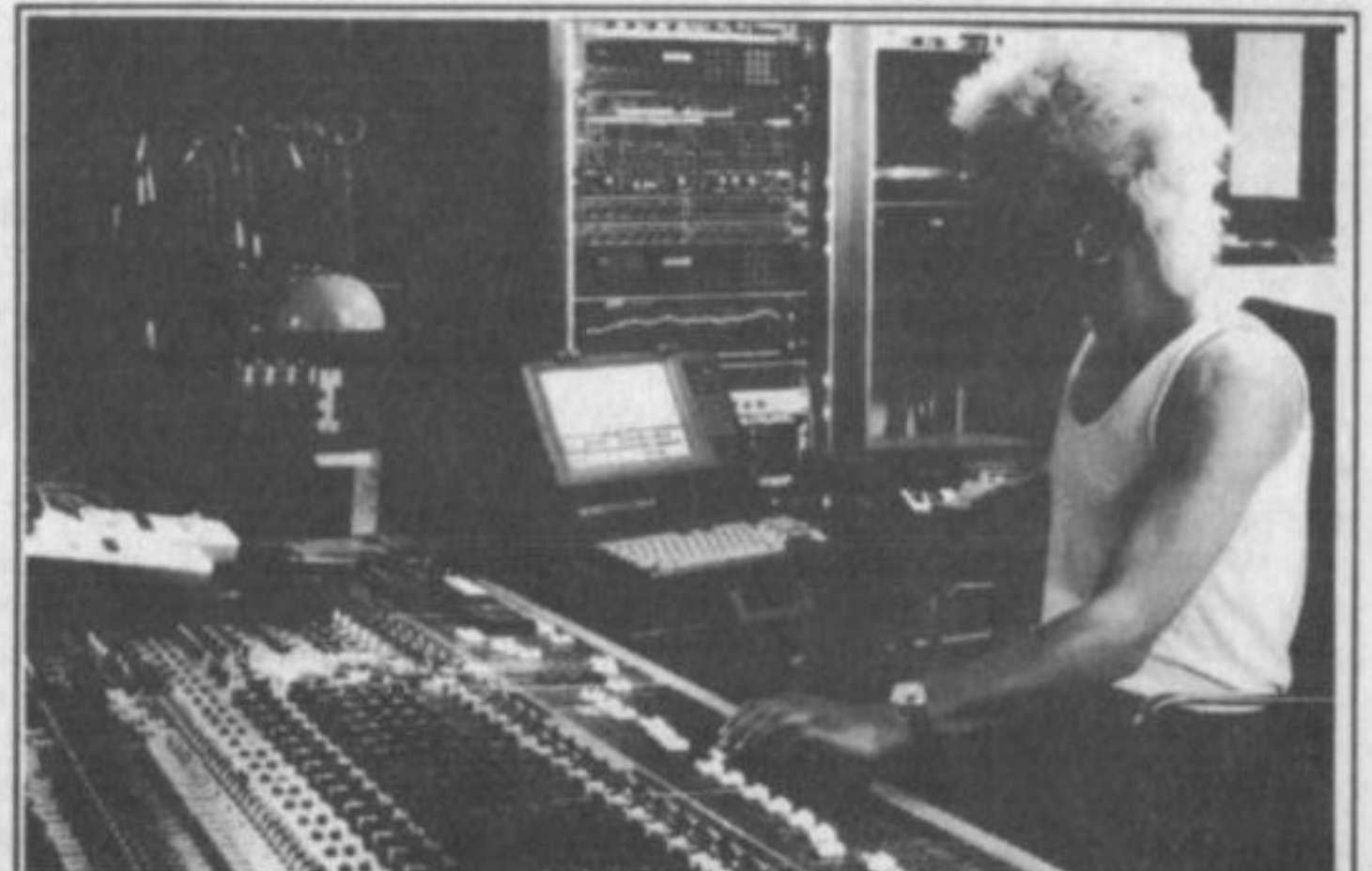
"Knädatoren" Stacy har 1 Mb Internminne och 3 1/2" diskettenhet. Här syns den uppkopplad mot en avancerad musikanläggning
