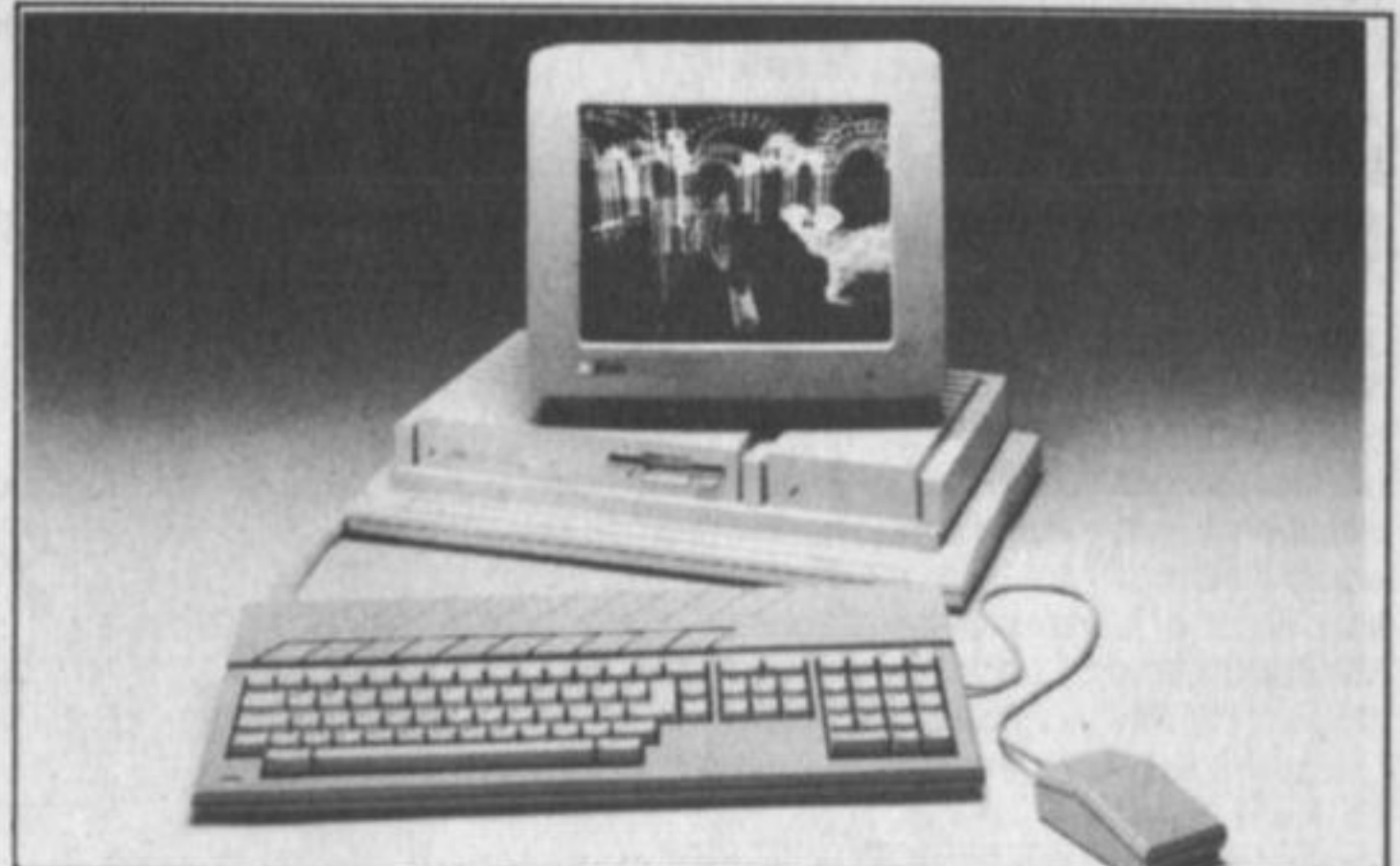
Atari TT är en arbetsstation för den avancerade användaren. Den är bl.a. förberedd för nätverk och kan ha upp till 26 Mb internt!
